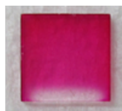
図2 グリーンス試薬含浸 \text{NO}_2 検出素子 \text{NO}_2 曝露後に赤紫色に着色
