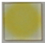
図1 KI/ \alpha -CD 含浸 \text{O}_3 検出素子 \text{O}_3 曝露後に黄色に着色
